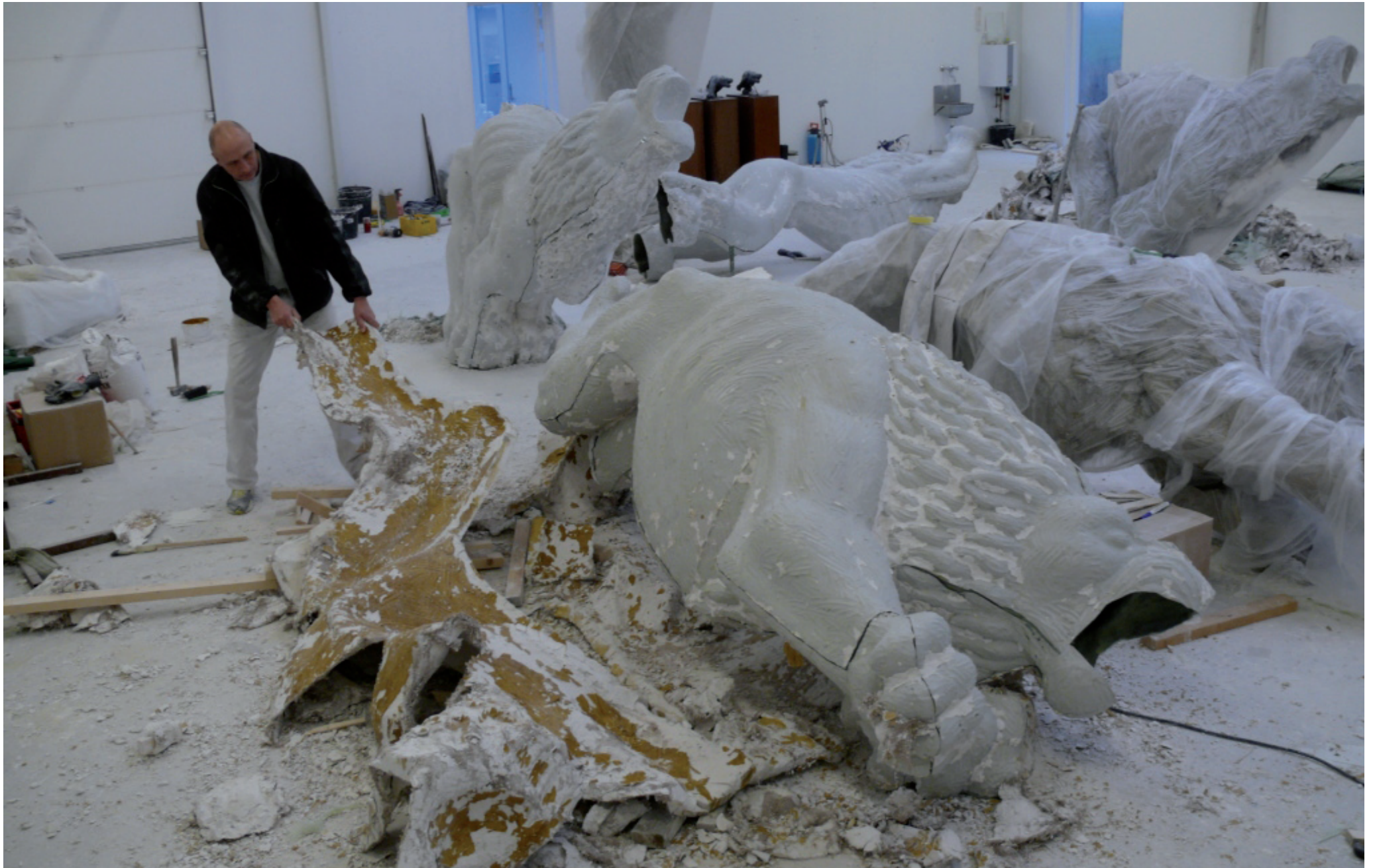
Gipsformene tages af glasfibermodellen
