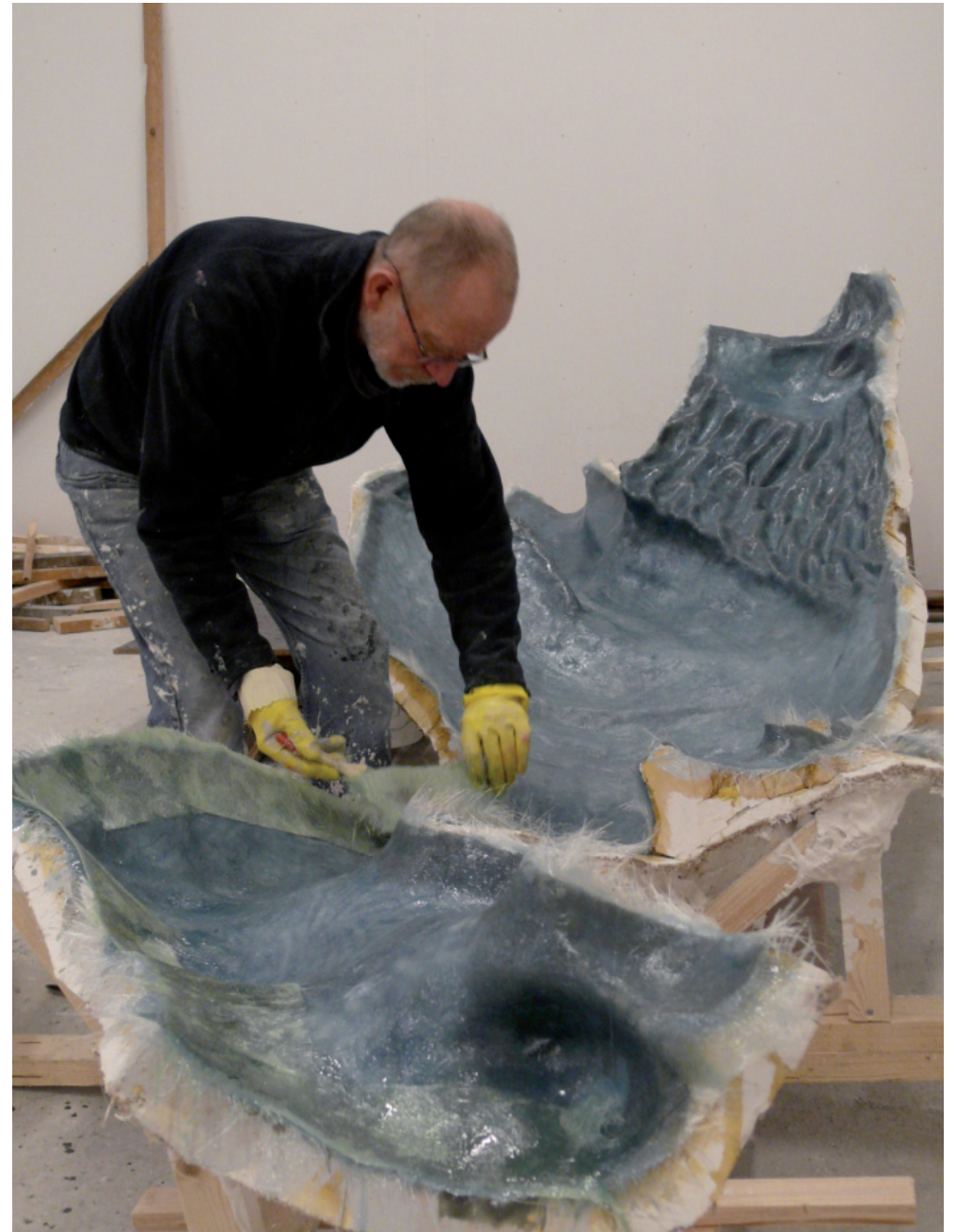
Glasfiberen lægges ind i formene
